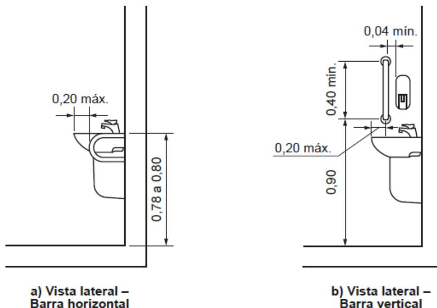
**Figura 114 – Barra de apoio no lavatório – Vista lateral**
