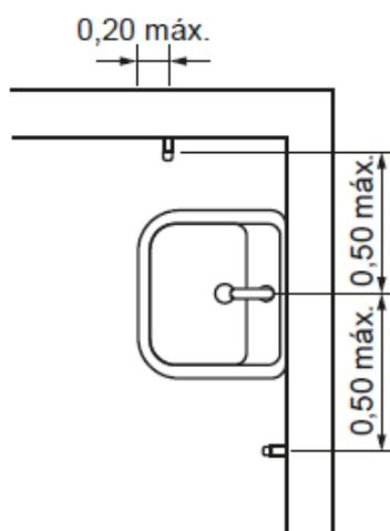
**Figura 113 – Barra de apoio no lavatório – Vista superior**
